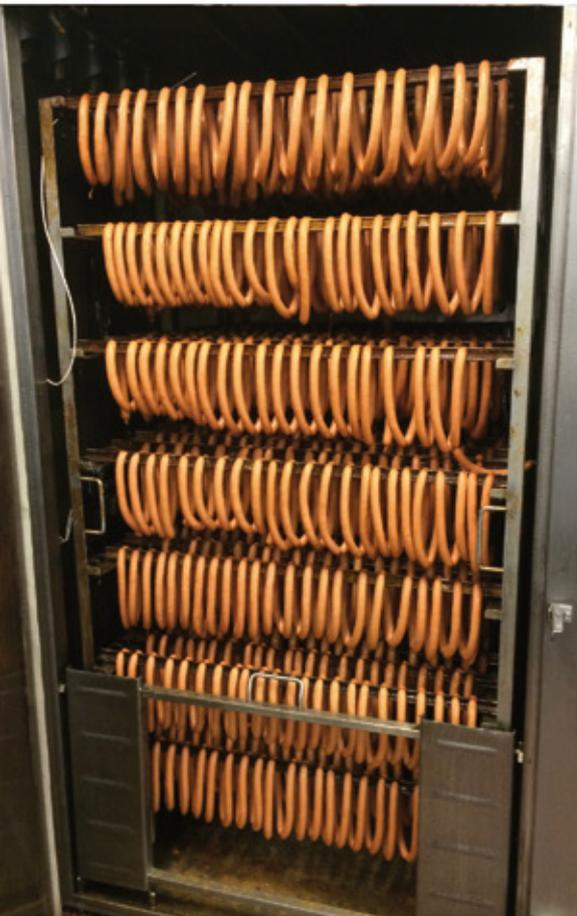
**Im Vergleich zu offenen Anlagen reduziert sich Ihr Bedarf an Räuchermaterial bei dem geschlossenen JET SMOKE-System um bis zu 40 Prozent. Nachverbrennungsanlagen, Rauchwäscher oder Katalysatoren sind überflüssig.**
